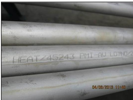
Beschriftung der nahtlosen Edelstahlrohre
